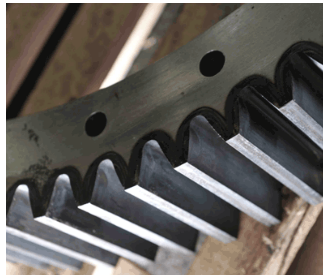
Tempra del dente fianco e fondo / Gear hardening flank and root of the teeth
